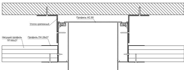
Установите несущий каркас к основному потолку и профилю НС 80 с учётом количества слоёв и толщины гипсокартона. Сразу выведите провод к месту подключения освещения.
