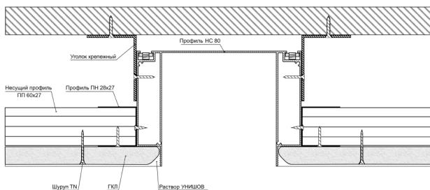
Установите гипсокартон к несущему каркасу с отступом от края лицевой стороны профиля НС 80 в 5 мм или снимите фрезу с гипсокартона под 45 градусов на углу. Затем выполните отделочные работы (стеклохолст, шпаклёвка, покраска).
