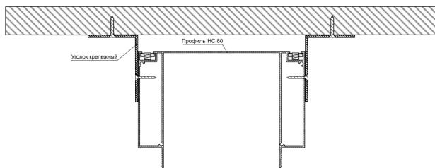
Соберите нужную конфигурацию профиля НС 80 с помощью соединителей и винтов, поставьте торцевые заглушки. Затем установите профиль на уголках к основному потолку.
