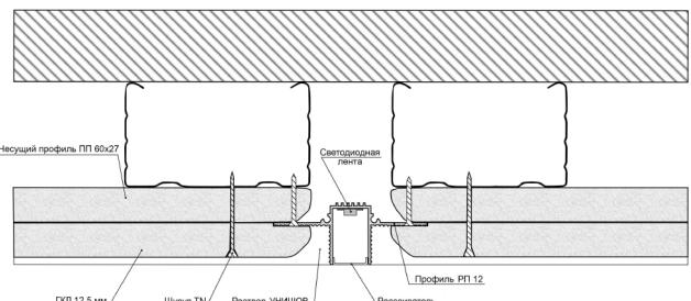
Выполните отделочные работы (стеклохолст, шпаклёвка, покраска). Если нужно, установите и подключите светодиодную ленту и установите рассеиватель.
