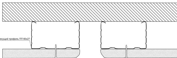
Установите несущий каркас к основному потолку. Если планируется светодиодная лента, сразу выведите провод к месту подключения. Затем установите верхний слой гипсокартона разрывом для профиля РП 12 в 30 мм.
