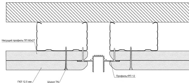
Сделайте фрезеровку листа гипсокартона в месте прилегания к профилю РП 12. Установите нижний слой гипсокартона к несущему каркасу с отступом от края лицевой стороны профиля РП 12 в 5 мм или снимите фрезу с гипсокартона под 45 градусов на углу.
