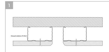
Установите несущий каркас к основному потолку. Если планируется светодиодная лента, сразу выведите провод к месту подключения. Затем установите верхний слой гипсокартона разрывом для профиля РП 12 в 30 мм.
