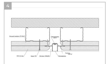
Выполните отделочные работы (стеклохолст, шпаклёвка, покраска). Если нужно, установите и подключите светодиодную ленту и установите рассеиватель.
