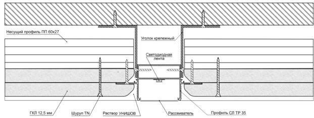
Выполните отделочные работы (стеклохолст, шпаклёвка, покраска). Если нужно, установите и подключите светодиодную ленту и установите рассеиватель или подключите шинопровод.
