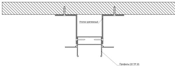
Установите профиль СЛ ТР 35 на уголках к основному потолку. Если планируется светодиодная лента или шинопровод, сразу выведите провод к месту подключения.
