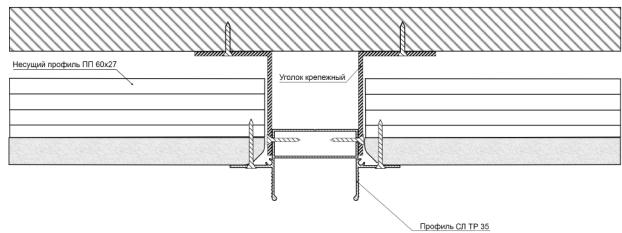
Установите несущий каркас к основному потолку, затем установите верхний слой гипсокартона. Затем сделайте зенковку отверстий в профиле СЛ ТР 35 в местах крепления и прикрутите его к несущему каркасу через гипсокартон.
