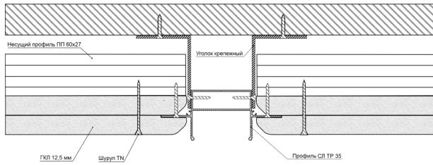
Сделайте фрезеровку листа гипсокартона в месте прилегания к профилю СЛ ТР 35. Установите нижний слой гипсокартона к несущему каркасу с отступом от края лицевой стороны профиля СЛ ТР 35 в 5 мм или снимите фрезу с гипсокартона под 45 градусов на углу.
