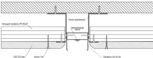
Сделайте фрезеровку листа гипсокартона в месте прилегания к профилю СЛ ТР 35. Установите гипсокартон на несущему каркасу с отступом от края лицевой стороны профиля СЛ ТР 35 в 5 мм или снимите фрезу с гипсокартона под 45 градусов на углу.
