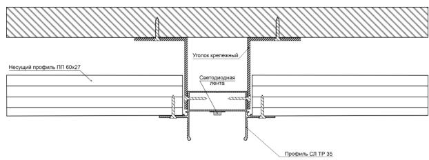
Сделайте зенковку отверстий в профиле СЛ ТР 35 в местах крепления и прикрутите его к несущему каркасу. Если нужно, установите и подключите светодиодную ленту или выведите провод для шинопровода.
