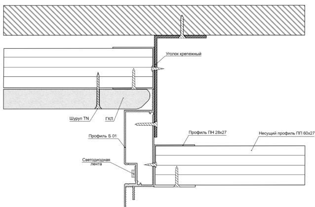
Установите профиль Б 01, затем установите каркас нижнего уровня с учётом количества слоёв и толщины гипсокартона. Если нужно, установите и подключите светодиодную ленту.
