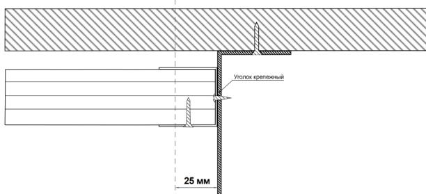
Сделайте отметку перехода уровня на основном потолке, затем сдвиньте отметку на 25 мм вглубь предполагаемого нижнего уровня – в этом месте будут стоять уголки. Установите верхнюю часть несущего каркаса на потолке, выставьте боковую грань на уголках до выбранной отметки.
