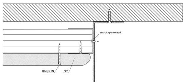
Установите гипсокартон для верхнего уровня потолка с отступом от края 5 мм или снимите фрезу с гипсокартона под 45 градусов на углу.
