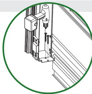
Крепления к полу специальными пластинами шириной 125 мм
