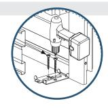
Конструкция пенала быстро собирается «в паз» и на саморезы, что придает конструкции прочность и жесткость.
