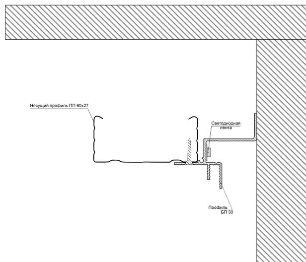
Сделайте зенковку отверстий в профиле БП 30 в местах крепления и прикрутите его к несущему каркасу. Если нужно, установите и подключите светодиодную ленту.
