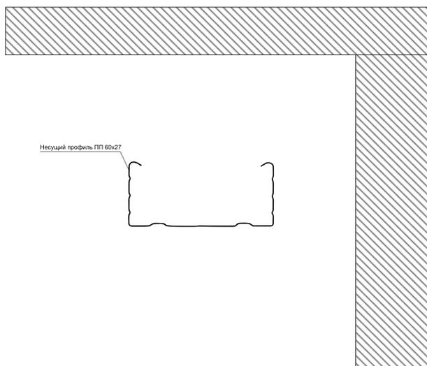
Установите несущий каркас к основному потолку с отступом от стены 35 мм.
