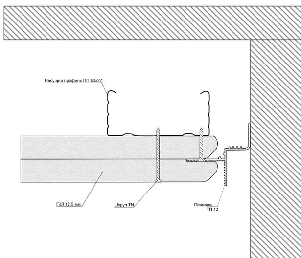
Сделайте фрезеровку листа гипсокартона в месте прилегания к профилю ТП 12. Установите нижний слой гипсокартона к несущему каркасу с отступом от края лицевой стороны профиля ТП 12 в 5 мм или снимите фрезу с гипсокартона под 45 градусов на углу.
