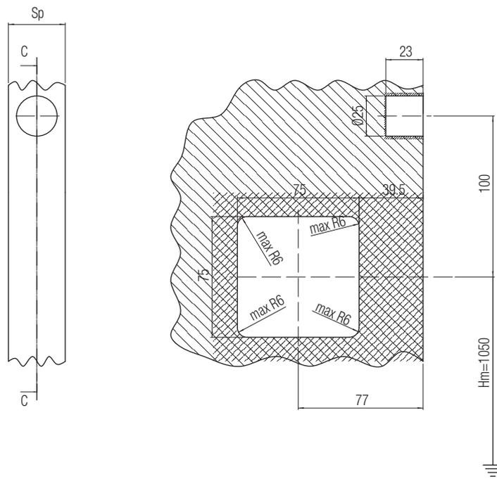
Sp= толщина дверного полотна мин. 35 мм – макс.50 мм
