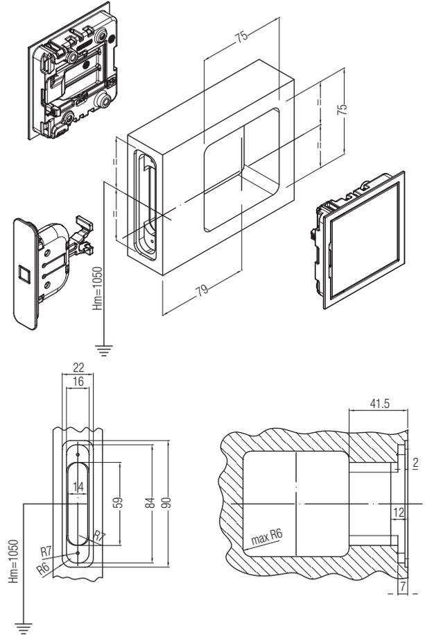
Sp= толщина дверного полотна мин. 35 мм – макс.50 мм
