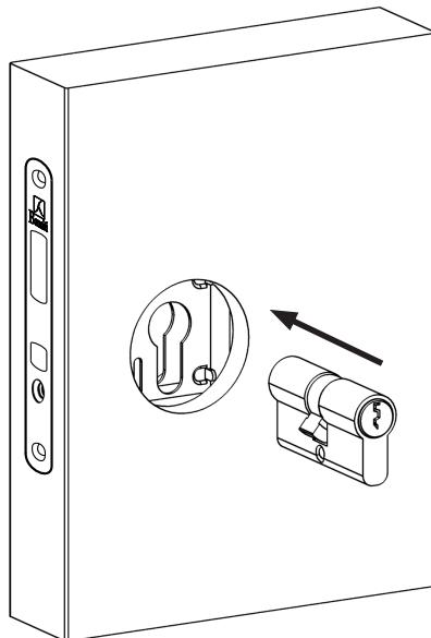
ATTENZIONE: nelle versioni "cilindro" della serratura, si raccomanda di utilizzare cilindri con camma DIN 30° e di installarli, come da immagine, con la camma rivolta verso la parte anteriore della serratura.
